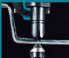
Держатель матрицы свободно вращается на 360° в зависимости от направления реза и формы материала, а также может быть зафиксирован под 90, 180, 270, 360°
