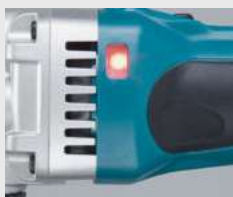
Сигнальная лампа. Загорается и горит постоянно красным, если аккумулятор разрядился ниже допустимого уровня. При этом устройство не включается
