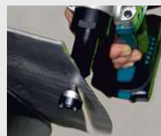
Стружка удаляется через специальное отверстие, не задерживаясь на материале. Отсутствие заусенцев
